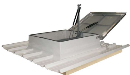
Lanterneaux de désenfumage (ouverture par treuil mécanique)
